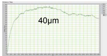
未補償X軸進給速率24 m/min之時間與熱變形關係圖
