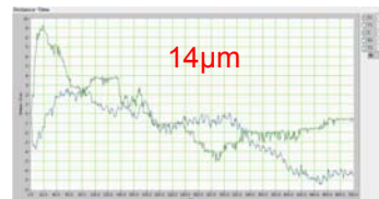
補償後X軸進給速率24 m/min之時間與熱變形關係圖
