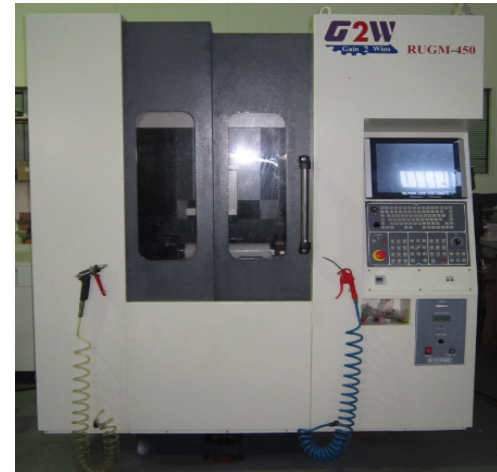
鴻碩機械公司 三軸門型結構超音波加工機 (可自動換刀超音波主軸)
