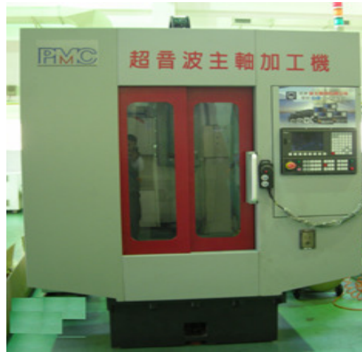
三軸超音波加工機 (可自動刀具交換BT30超音波 刀把與主軸)
